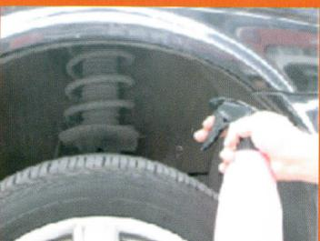
Stabilito il codice giusto per la propria vettura, pulire e lubrificare la parte per facilitare l'inserimento del cuscinetto.
